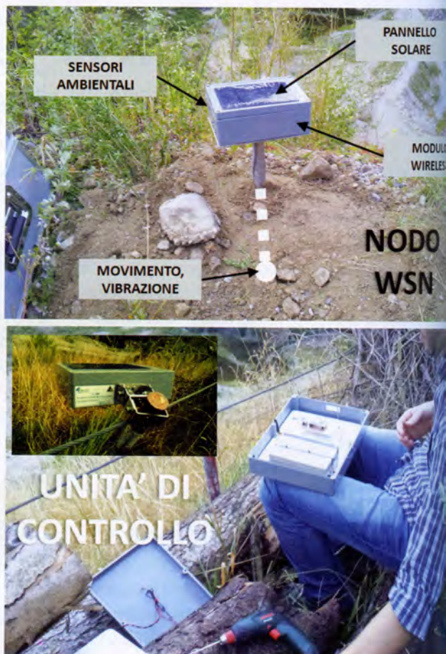
Figura 3 - Dispositivi prototipali della rete WSN, esempio di nodo (a) e unità di controllo (b).
